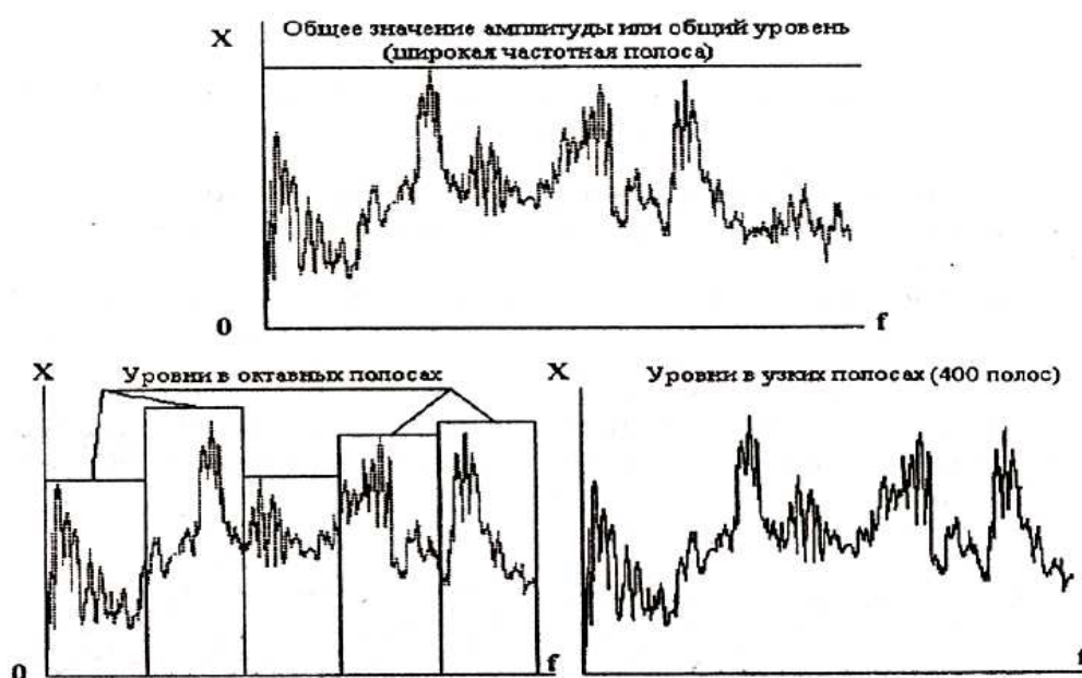
Рис. 4. Спектры вибрации, измеренной с различной разрешающей способностью.
